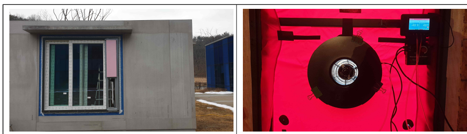
[그림 5-5] 기밀성능챔버에서의 기밀자재 성능비교를 위한 Pilot Test
