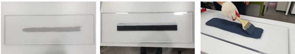
[그림 4-17] 기존 실란트 마감(좌), 기밀테이프(중), 탄성도막제 도포(우)
