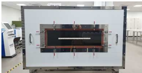
[그림 4-19] 기밀자재 시료 장착 후 시험 모습
