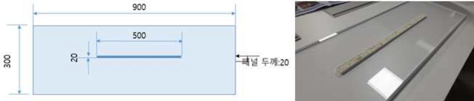
[그림 4-16] 아크릴 시편 제작 개요(좌) 및 우레탄 폼 충전(우)
